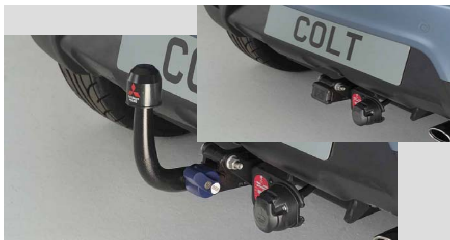
MZ313120 Прицепное устройство съемное MZ313121 Проводка для прицепа 7-pin
